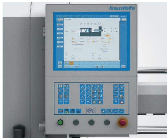
Tela colorida multitoque de 15" para o controle da máquina
